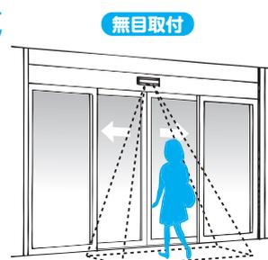
赤外線やマイクロ波（電波）の反射により物体を検知し、ドアが開きます。
